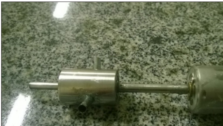
FIGURA 11 – Turbina montada (vista lateral I)
