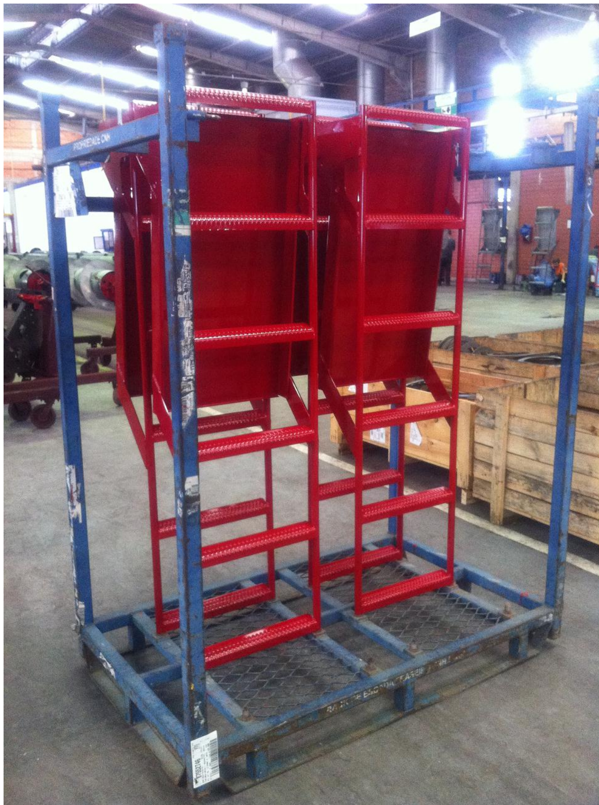
Figura 17: Escada pintada acondicionada no rack de transporte
